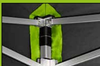
Aan iedere hoek van het zeil zijn er 2 velcro-banden voorzien. Wikkel deze rond de hoekpaal en span strak aan. Zorg er wel voor dat de PVC-bescherming in de hoek niet dubbel zit achter de paal.
