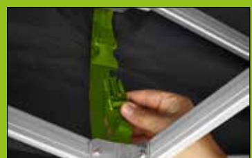
Klik overal aan de binnenkant van het dakzeil de spanriempjes los. Plaats je voet op het grondplaatje. Duw het frame lichtjes omhoog en trek aan de ring. Laat het frame zakken.
