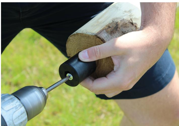
De houtadapters voor de masttoppen worden steeds door middel van de meegeleverde schroef vastgemaakt op de houten paal.
