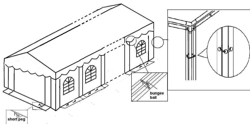
Befestigen Sie die Spannleinen an jeder oberen Ecke des Zelts und verspannen Sie die anderen Enden mit den großen Erdnägeln im Boden.
