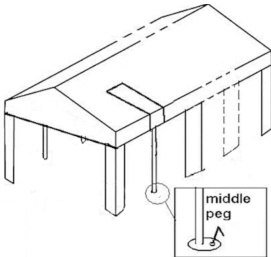
Befestigen Sie die Seiten- und Endwände mit den Kugelgummischlaufen am Zelt. Verwenden Sie nur eine Gummischlaufe, um das Dach, den Rahmen und die Wand zu verbinden. Verwenden Sie die kurzen Erdnägel, um die Wände im Boden zu befestigen.
