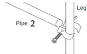
Setzen Sie alle Stangen und Verbinder wie gezeigt in den Zeltrahmen ein. Ziehen Sie die Schrauben gut an.
