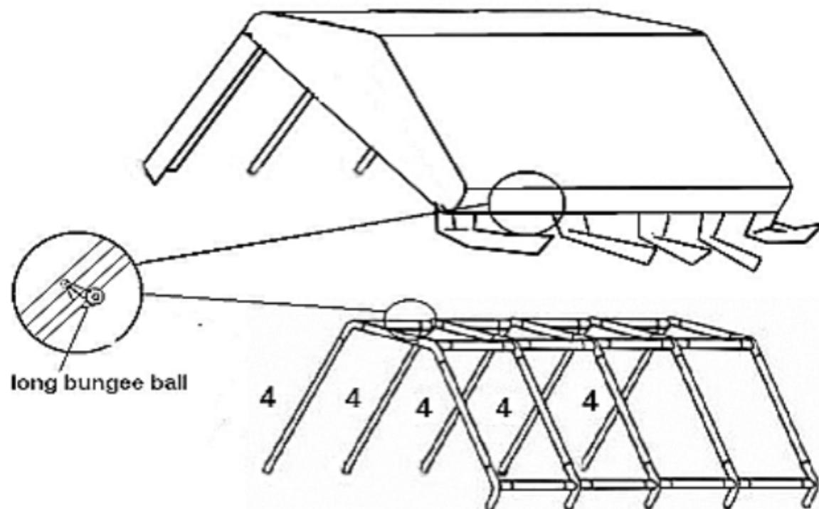
Stecken Sie die Beine (ID-Nr. 4) mithilfe der Verbindner (ID-Nr. 6 und 7) auf der gegenüberliegenden Seite des Zelts ein. Verwenden Sie die langen, dünnen Erdnägel, um jedes Bein im Boden zu verankern und befestigen Sie die Dachschals am Dach mithilfe des Hakens an den Beinen.
