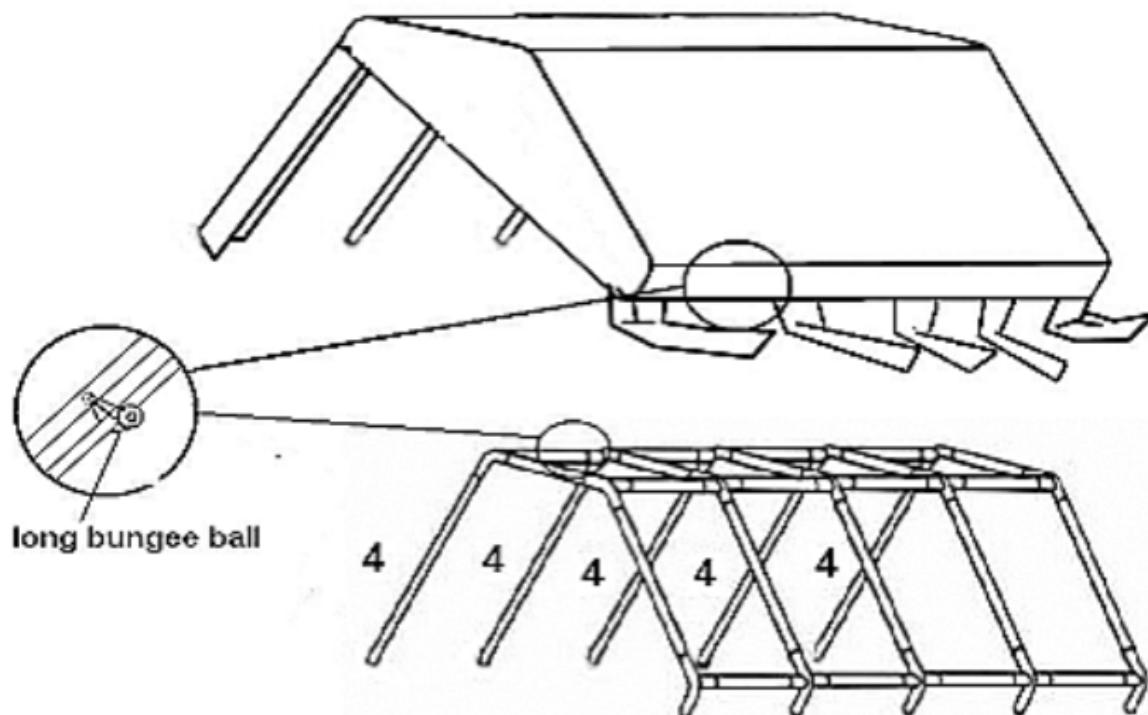
Montez les tubes verticaux (pièce 4) de l'autre côté de la tente à l'aide des raccords (pièces 6, 7). Utilisez les longs piquets fins pour ancrer chaque poteau dans le sol et fixez les rabats de la bâche de toit aux pieds à l'aide du crochet.
