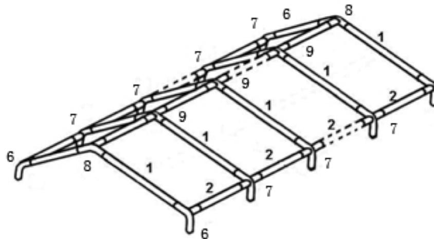
Stecken Sie die Beine (ID-Nr. 4) an einer Seite des Zelts mithilfe der Verbinder (ID-Nr. 6 und 7) ein.
