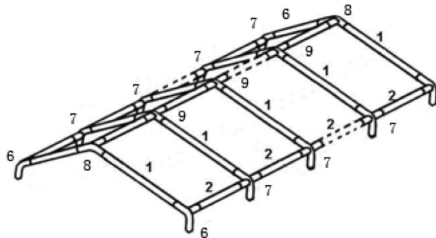
Montez les tubes verticaux (pièce 4) d'un côté de la tente à l'aide des raccords (pièces 6 et 7).
