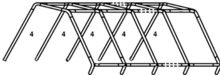
Setzen Sie das Dach auf den Rahmen und befestigen Sie es mit den Kugelgummischlaufen. Achten Sie darauf, dass die Gummischlaufen nicht zu stark gespannt werden, sodass Sie später die andere Zeltseite ebenfalls einfach montieren können.
