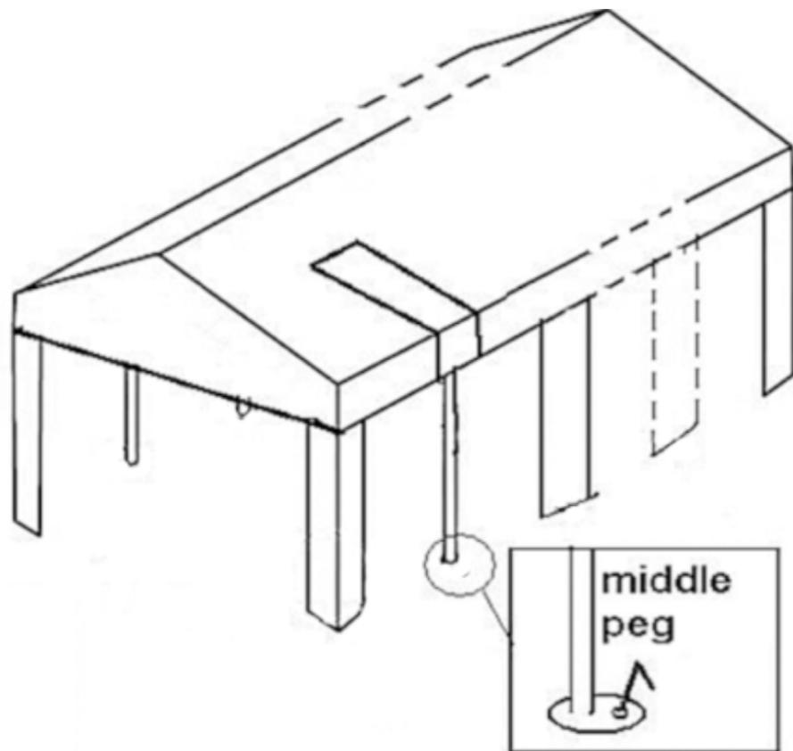
Montez les parois latérales et le fond de la tente avec les élastiques à boules. N'utilisez qu'un seul élastique à la fois pour arrimer ensemble la bâche de toit, la structure et la paroi. Utilisez les piquets courts pour fixer les parois au sol.
