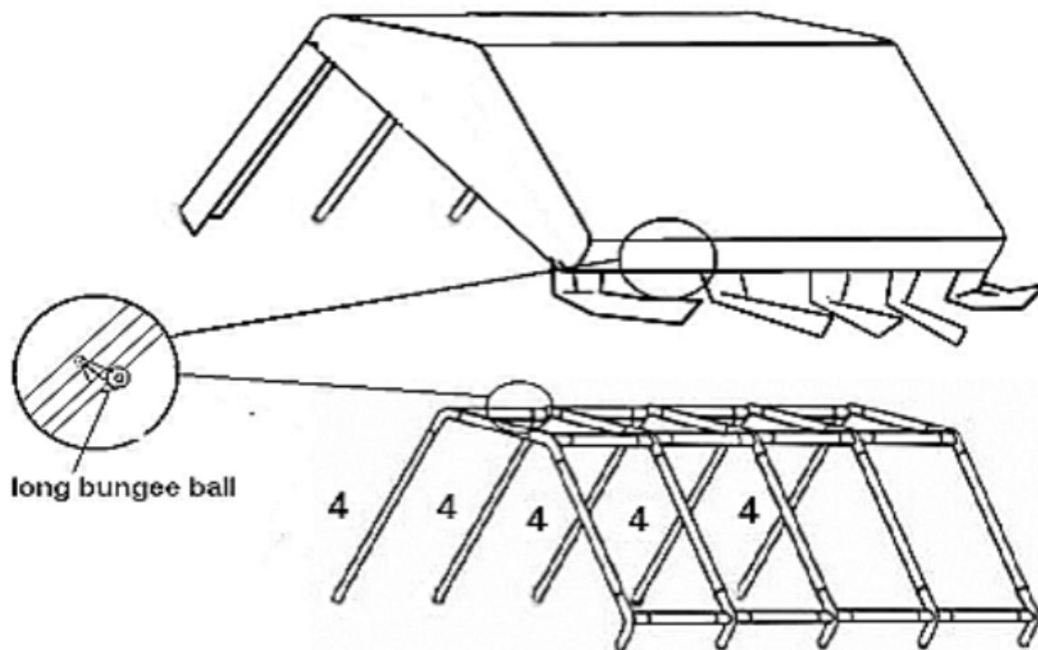
Monteer de verticale buizen (onderdeel 4) aan de andere zijde van de tent met behulp van de connectoren (onderdeel 6 en 7). Monteer het dakzeil op de structuur en maak het vast met de elastieken met bolletjes. Gebruik de lange smalle haringen om elke paal in de grond te verankeren en maak de flappen aan het dakzeil vast aan de poten met behulp van het haakje.
