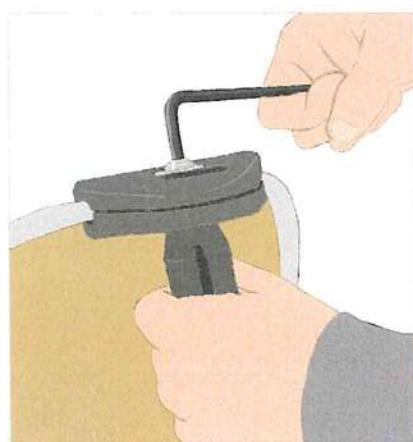
Vérifiez sur le plan de montage l'emplacement des zones renforcées et fixez les pinces de fixation latérales aux points indiqués. Tendez toujours correctement les pinces de fixation latérales. Pour ce faire, vous pouvez utiliser la clé Allen fournie dans le sachet zip.
