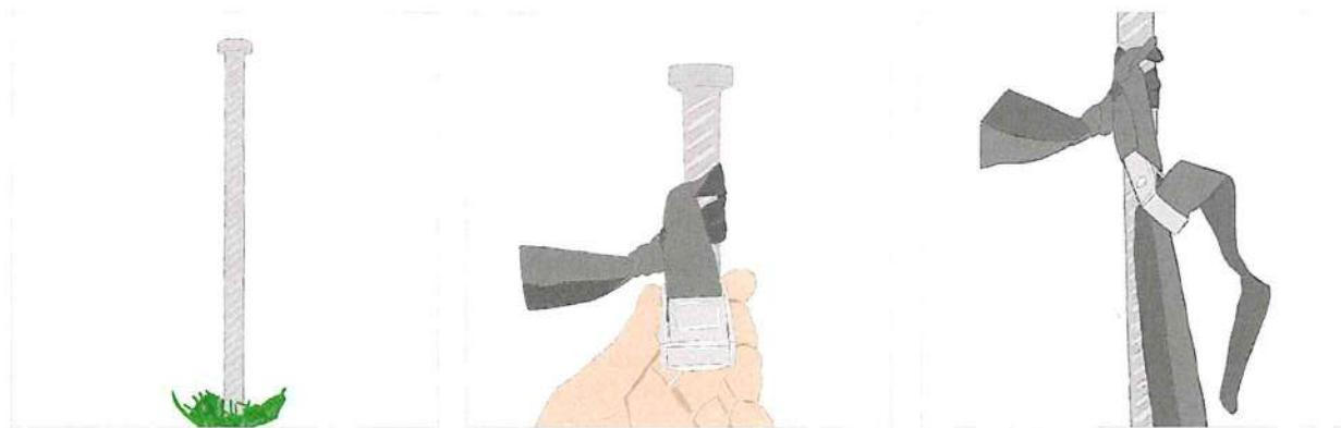
Laat de spanriemen momenteel nog los op de grond liggen en zet ze nog niet op spanning. De spanriemen mogen pas op spanning gezet worden nadat de palen onder de tent werden opgesteld.
