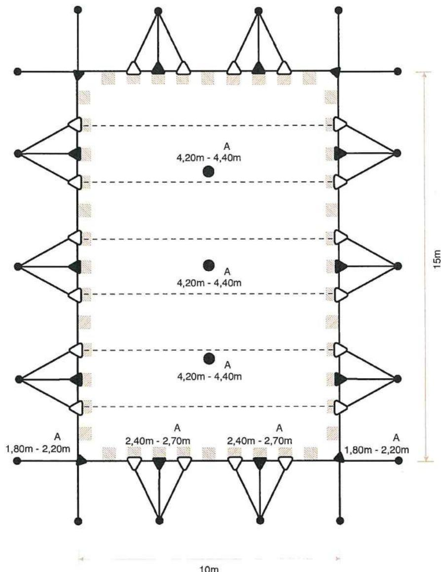
\* Wenn die Pfähle außerhalb des Zelttuchs positioniert werden, dann müssen die Anweisungen zur Verwendung der Augenmutter mit Gewindestange von Schritt 5 (bei Holzpfählen) und Schritt 6 (bei Aluminiumpfählen) befolgt werden.
