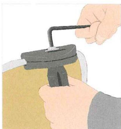
Überprüfen Sie auf dem Bauplan, wo sich die verstärkten Bereiche befinden, und befestigen Sie die Seitenklemmen an den angegebenen Stellen. Ziehen Sie die Seitenklemmen stets fest an. Sie können dazu den Inbusschlüssel verwenden, der im Zip-Beutel enthalten ist.
