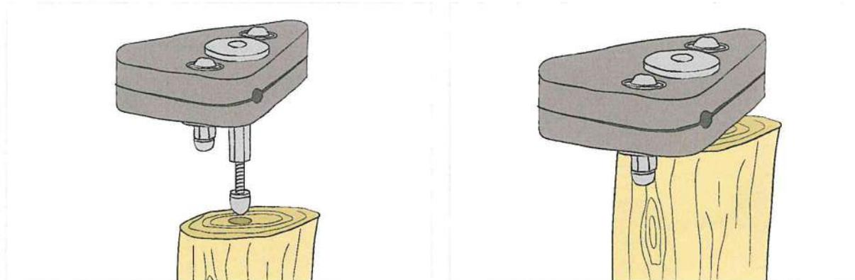
Schrauben Sie den Adapter für Holzpfähle mit einer ca. 10 cm langen Schraube an der Oberseite der Mittelposten fest. Schieben Sie anschließend die mitgelieferten Mastköpfe (klein oder XL) über den Holzadapter.
