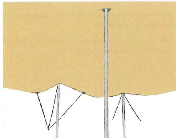
**TIPP** – Bei Zelten ab 10 x 10 ist es nicht einfach, die Mittelpfähle direkt an der gewünschten Stelle zu positionieren. Es ist am besten, zunächst nur einen Pfahl an einer beliebigen Stelle zu positionieren, damit das Zelttuch gehalten wird und weniger Druck ausübt, um die anderen Mittelpfähle an den gewünschten Stellen zu positionieren. Der erste Pfahl, den Sie als Stütze verwenden, setzen Sie dann als letzten an die gewünschte Position.
