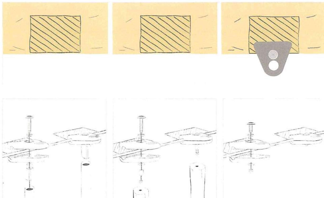
Zijklemmen waaronder een aluminium paal komt te staan schuiven gemakkelijk in de paal en bevestig je door middel van de handklem.
