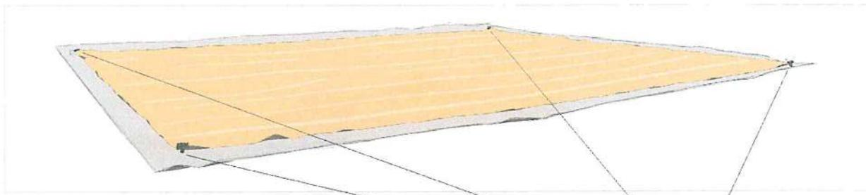
Quatre pinces de fixation angulaires sont déjà fixées aux coins de la toile stretch. Celles-ci ne doivent pas être enlevées ni déplacées. Vérifiez toujours que les pinces de fixation angulaires sont suffisamment serrées. La pince manuelle de la pince de fixation angulaire doit toujours se trouver en bas.
