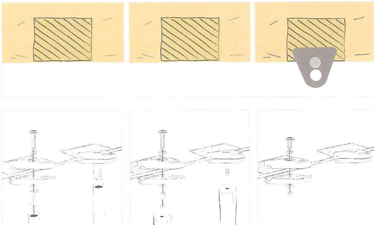
Les pinces de fixation latérales sous lesquelles un mât en aluminium sera placé glissent facilement dans le mât et sont fixées à l'aide de la pince manuelle.
