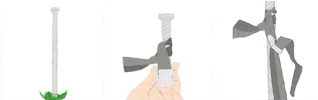
Lassen Sie die Spannriemen vorerst lose auf dem Boden liegen und setzen Sie diese noch nicht unter Spannung. Die Spannriemen dürfen erst nach dem Aufstellen der Pfähle unter dem Zelt unter Spannung gesetzt werden.
