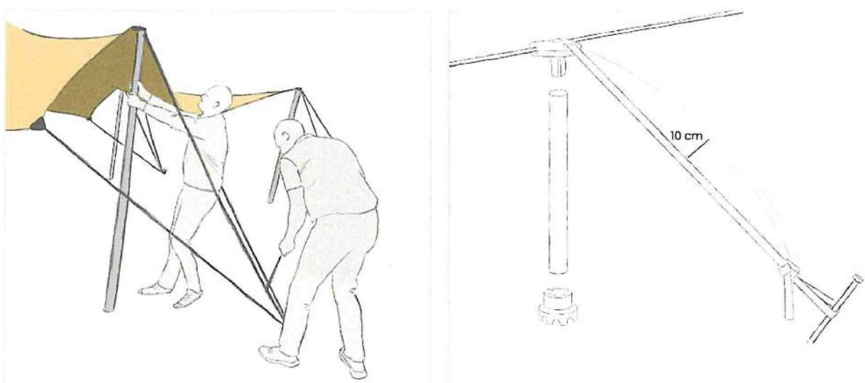
**CONSEIL** - La sangle de tension peut bouger d'avant en arrière d'environ 5 cm pour obtenir une tension parfaite.
