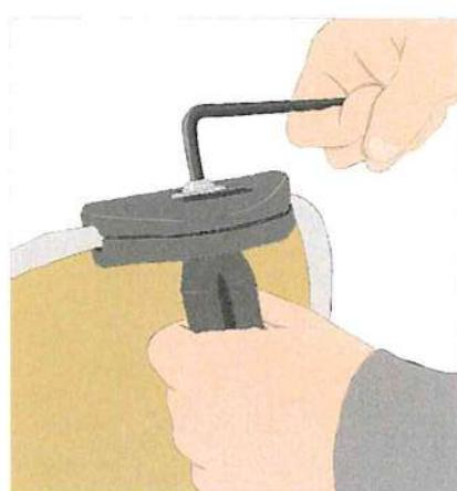
Ga na op het bouwplan waar de versterkte zones aangebracht zijn en bevestig de zijklemmen op de aangegeven punten. Span de zijklemmen steeds goed aan. Je kan hiervoor de meegeleverde inbussleutel gebruiken die in het gripzakje bijgevoegd werd.
