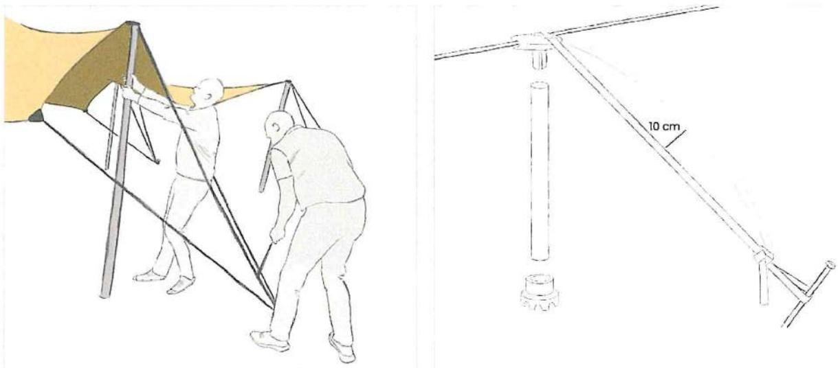
**TIPP** – Der Spannriemen kann sich um etwa fünf Zentimeter hin- und herbewegen, um eine optimale Spannung zu erreichen.
