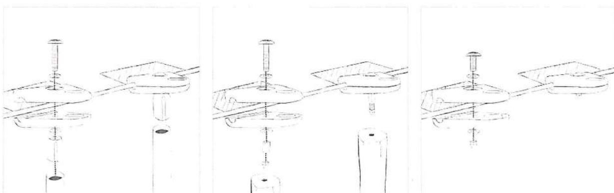
Seitenklemmen, unter denen ein Aluminiumpfahl positioniert wird, schieben sich leicht in den Pfahl und werden mit der Handklemme befestigt.
