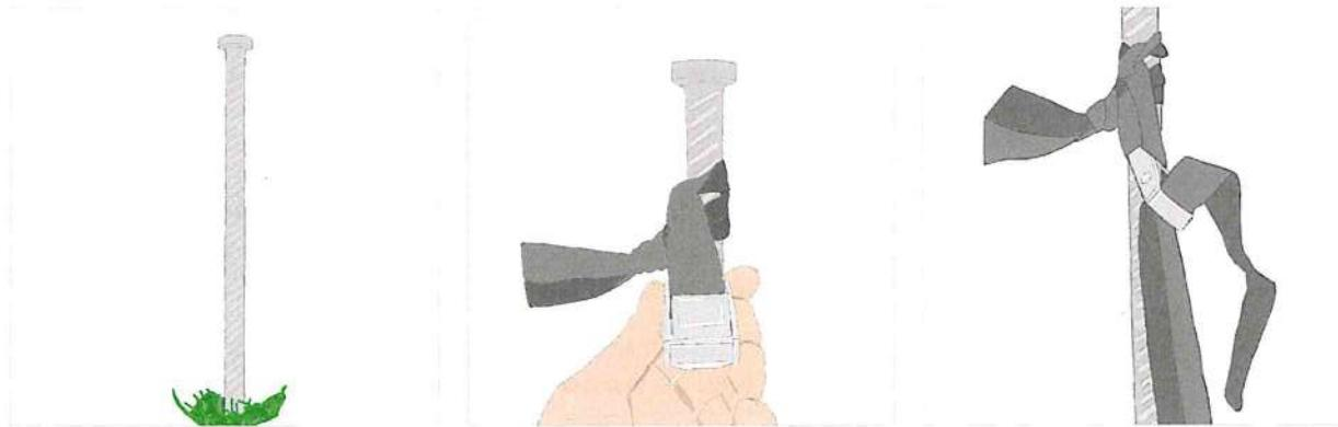
Pour l'instant, laissez les sangles de tension libres sur le sol et ne les tendez pas encore. Les sangles ne doivent être tendues qu'après avoir installé les mâts sous la tente.
