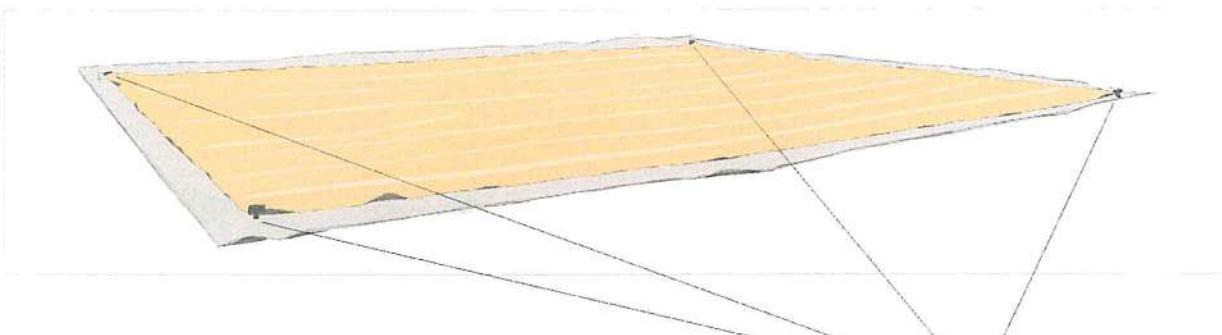
Op de hoeken van het stretchdoek zijn reeds 4 hoekklemmen bevestigd. Deze mogen niet verwijderd of verplaatst worden. Controleer steeds of de hoekklem voldoende aangespannen is. De handklem van de hoekklem moet zich steeds aan de onderkant bevinden.
