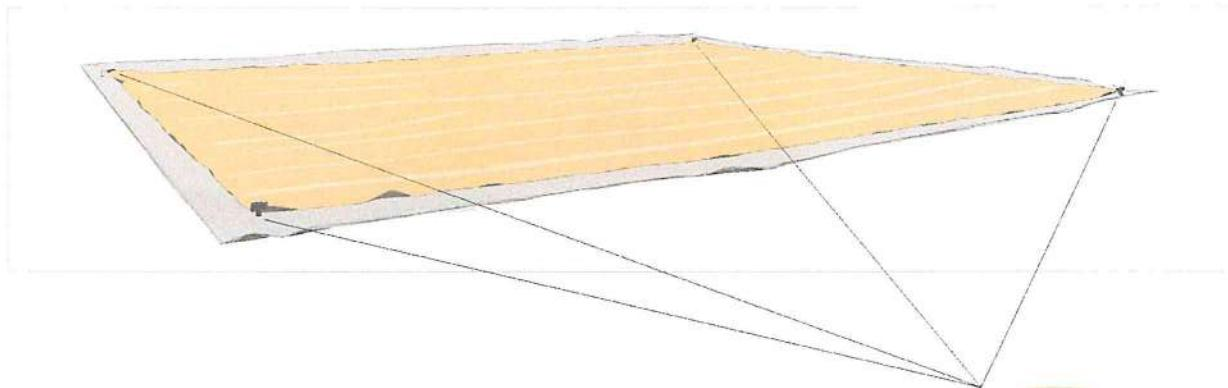
An den Ecken des Stretchtuchs sind bereits vier Eckklemmen befestigt. Diese dürfen nicht entfernt oder versetzt werden. Überprüfen Sie stets, ob die Eckklemme ausreichend angezogen ist. Die Handklemme der Eckklemme muss sich stets an der Unterseite befinden.
