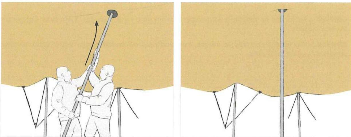
**CONSEIL** – Dans le cas des tentes à partir de 10 sur 10, il n'est pas simple de placer les mâts centraux directement dans la position souhaitée. Il est conseillé de placer d'abord un mât au hasard afin que la toile soit maintenue en hauteur et exerce moins de pression pour positionner les autres mâts centraux aux positions souhaitées. Le premier mât que vous avez utilisé comme support est le dernier à être placé dans la position souhaitée.
