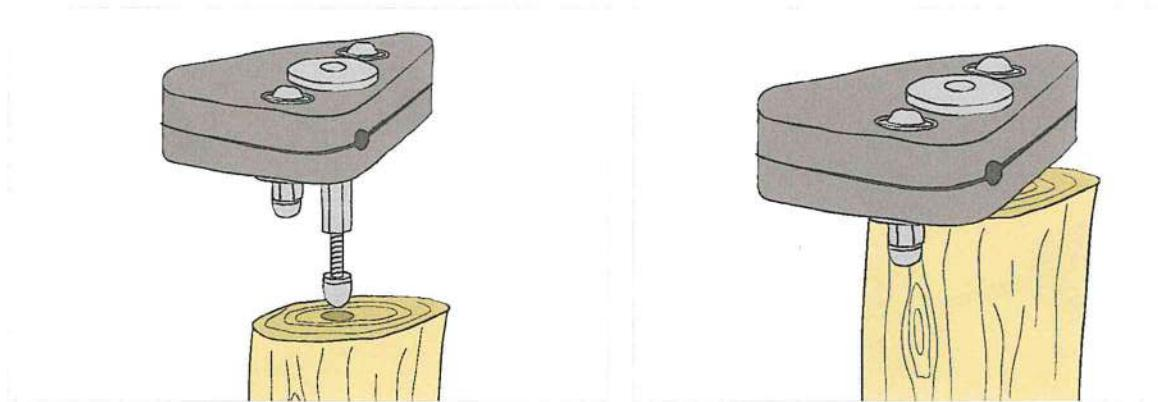
Vijs de adaptor voor houten palen vast bovenaan de middenpalen met een schroef van om en bij de 10 cm. Schuif daarna de bijgeleverde masttoppen (klein of xl) over de houtadapter.
